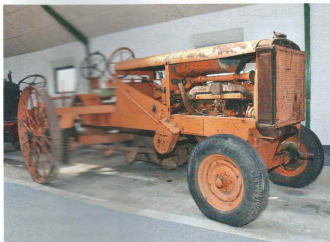
Amerikkalainen Cleveland Formgrader on yhden työn traktori. Koneen alla oleva ruuvi muotoilee pellon pinnan. Yhtiön valmistamia salaajakoneita tuotiin Suomeenkin.
