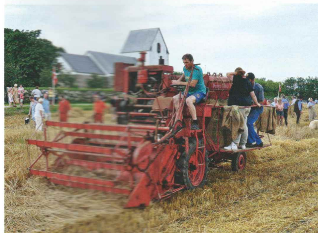
Köla Kombi ahmii lakoviljaa koko 1,9 metrin työleveydellä Morsøn syyspäivätapahtumassa. Puimurin rattaista pyörittää Mersun OM 636 -diesel 34 hv:n teholla. 50-luvun tapaan vilja säkitettiin. Lisävarusteisiin kuului 10 hehtolitrin tankki. Suomen Koneliike Oy toi Kölat Suomen pelloille vuonna 1960.
